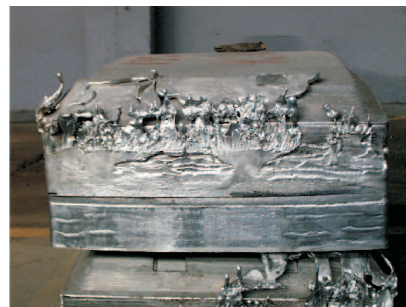
Figura 4: Derramamiento de aluminio en las bases de las placas
