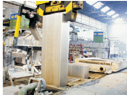
Figura 6: Solidificado el lingote, se desplaza la mesa de colada y se extrae.
