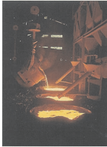
Figura 5: Esquema y foto de la colada clásica.
